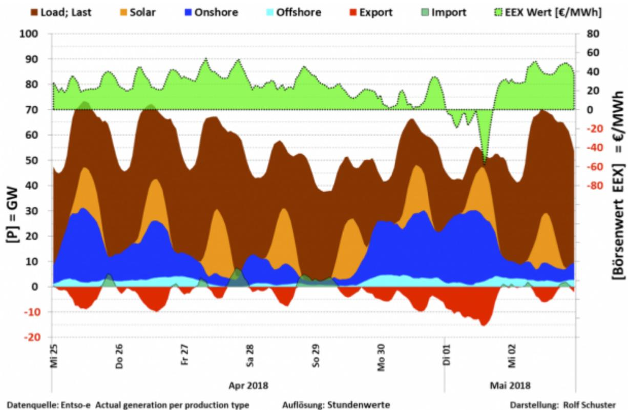
Verlauf der Erzeugung vom 25.4.18 bis 1.5.18 aus verschiedenen Quellen. Trotz der bereits verfügbaren Einspeiseleistung mittels Wind + Solarstromerzeugern von > 100 GW, blieb deren gelieferte Leistung weit unter dem Bedarf. Der Rest musste konventionell erzeugt werden.
