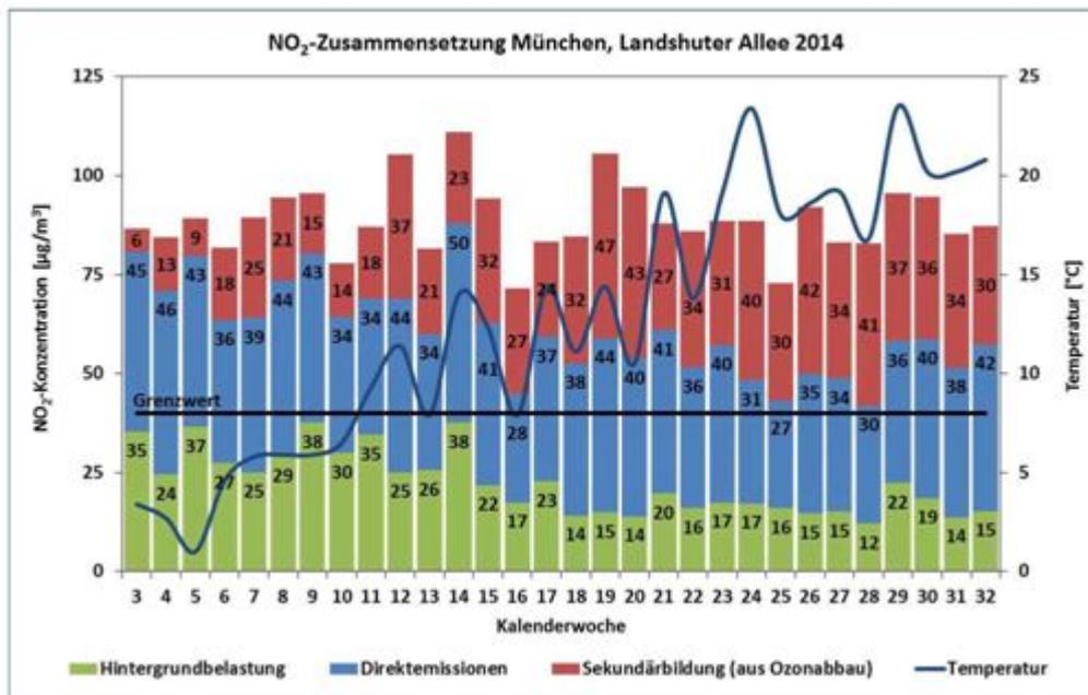
**Bild 10.** Wochenmittel der NO<sub>2</sub>-Immissionsfracht an der Landshuter Allee im ersten Halbjahr 2014 mit zusätzlicher Angabe der Temperatur (Grafik: [BLFU])
