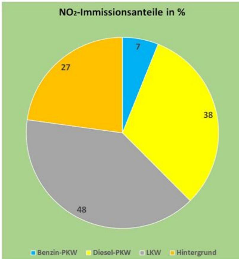
**Bild 11.** Prozentuale Anteile der verschiedenen Emissionsquellen an den NO<sub>2</sub>-Immissionswerten der Landshuter Allee in München im Jahr 2014, berechnet auf Basis der Daten der Bilder 2, 3 und 10
