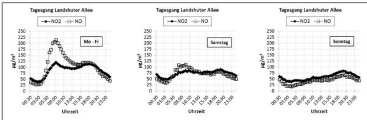
**Bild 8.** Mittlere Tagesgänge von NO und NO<sub>2</sub> am Münchner Brennpunkt Landshuter Allee an Wochentagen sowie an Samstagen und Sonntagen (Grafik: [BLFU])
