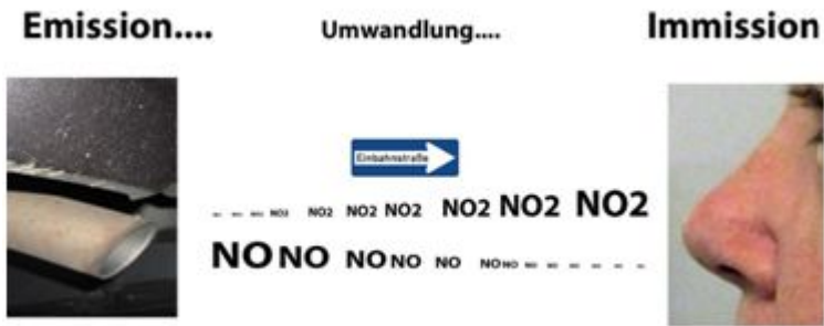
Bild 5. Naturgesetze sorgen dafür, dass der größte Teil der aus dem Auspuff entweichenden NO-Emissionen bis zum Ort und Zeitpunkt der Immissionsbestimmung zu NO 2 umgewandelt ist
