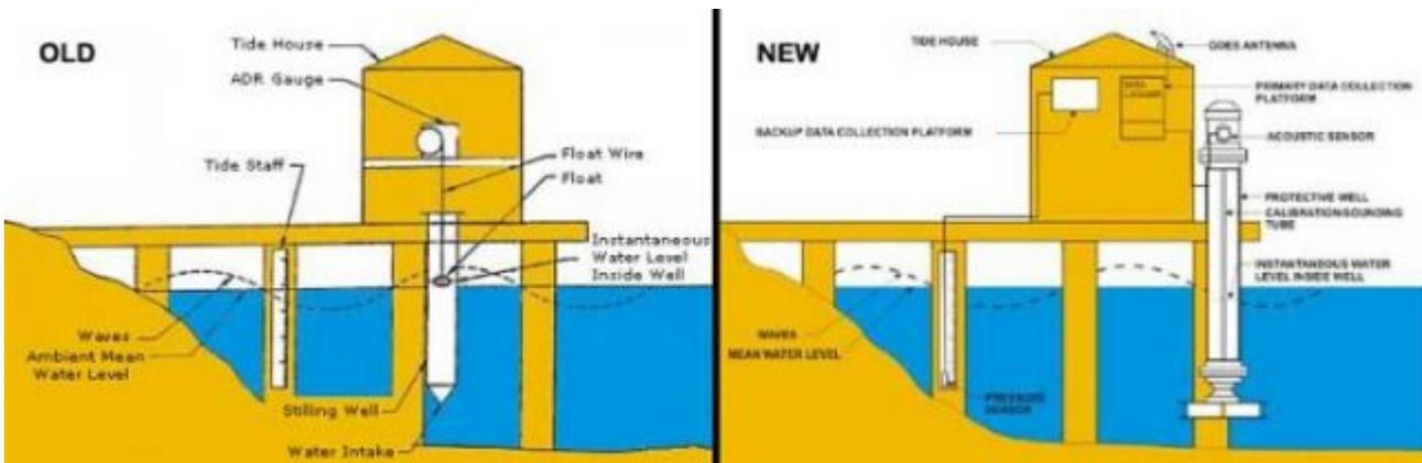
Das Bild oben zeigt schematisiert alte und neue Messverfahren. Die in den USA derzeit gebräuchlichen Verfahren hat die NOAA in einem PDF hier zusammengestellt. Bei den neuesten Geräten ergibt sich eine Unsicherheit von plus/minus **2 Zentimetern** bei individuellen Messungen und plus/minus **5 Millimeter** für monatliche Mittelwerte.
