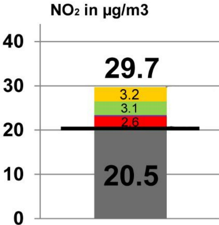
Bild 17. Projektion der 2020 an der Messstelle „Am Neckartor“ zu erwartenden NO<sub>2</sub>-Werte. Grau: Hintergrund, Gelb: Diesel-PKW, Grün: Benzin-PKW, Rot: schwere LKW (Grafik: IFKM/KIT)
