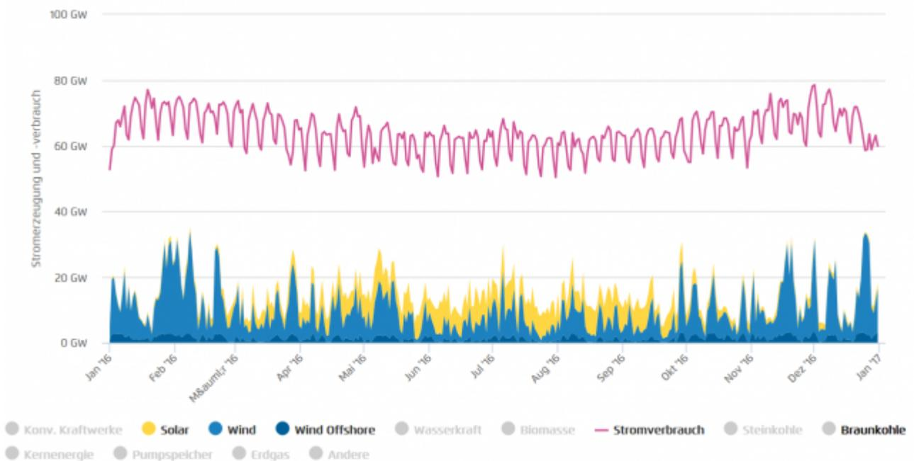
Bild 4 Ganglinie von Stromverbrauch und Einspeisung Windkraft gesamt + Solar im Jahr 2016. Quelle: Agora-Viewer
