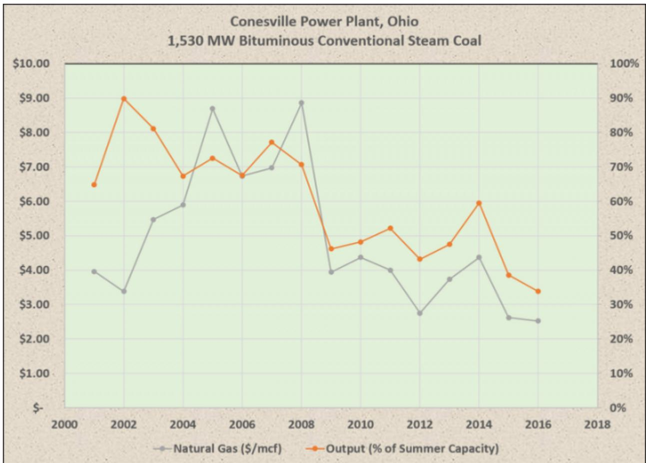
Kraftwerk Conesville, Ohio. Output als Prozent der Kapazität und Erdgaspreise 2001 bis 2016 (US EIA).
