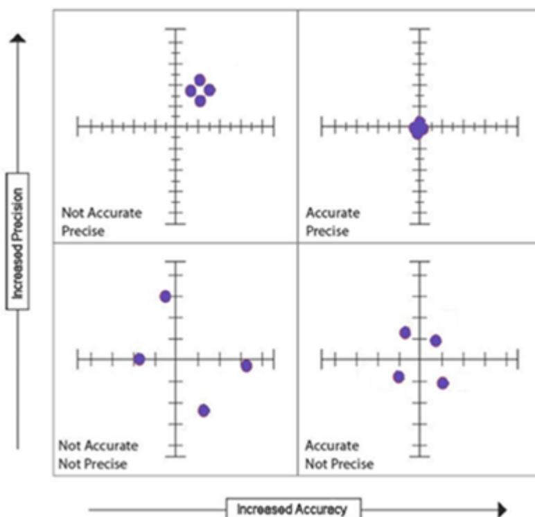
Die Abbildung impliziert, dass Reproduzierbarkeit oder verringerte Varianz Teil von Präzision ist. Das ist so, aber noch wichtiger ist die Fähigkeit, mit größerer Sicherheit aufzuzeichnen, wo eine Messung im Kontinuum einer Messskala lokalisiert ist. Geringe Genauigkeit ist die Folge systematischer Fehler. Sehr geringe Präzision jedoch, welche sich aus Zufallsfehlern oder ungeeigneter Instrumentierung ergibt, kann dazu beitragen, dass individuelle Messungen geringe Genauigkeit haben.
