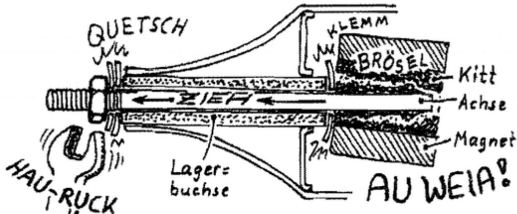
Bild 4 Windradgenerator-Montage. Quelle: Heft 1: Windkraft – ganz einfach!
