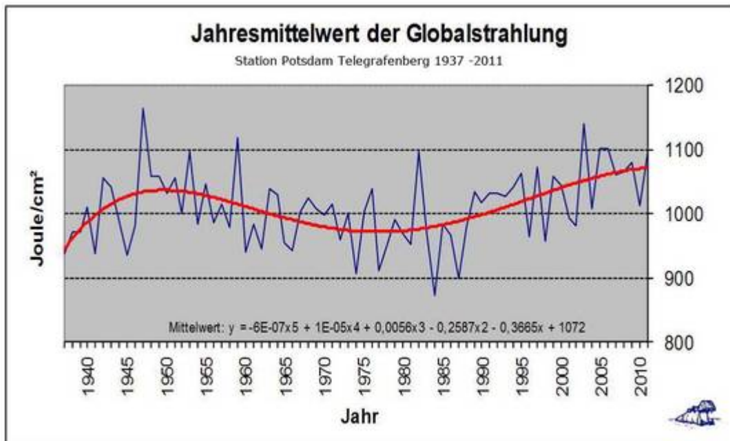
Abbildung 2: Gemessene Globalstrahlung an der Station Potsdam Telegrafenberg 1937-2011 [3]. Anmerkung: Die Einheit für die Globalstrahlung ist 1 Joule = 1 Watt x 1 Sekunde = 1 Ws. 1000 Joule/cm 2 entsprechen damit einem Wert von 2,78 kWh/m 2
