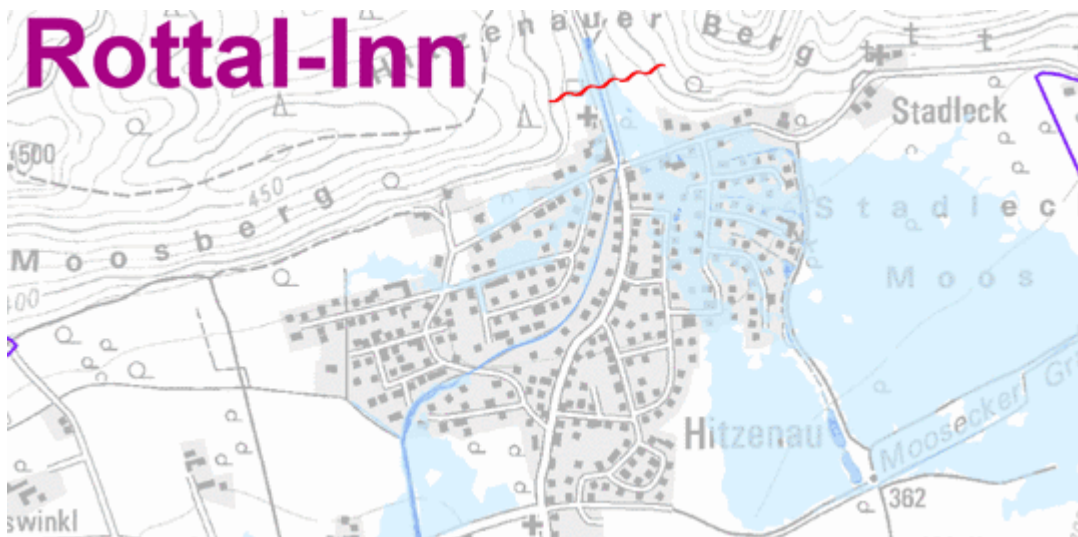
Bild 8 Auszug aus der LFU Bayern Hochwasser-Gefahrenkarte HQExtrem Blattschnitt:1871382_HITBA7_K1, Darstellung der Wassertiefen
