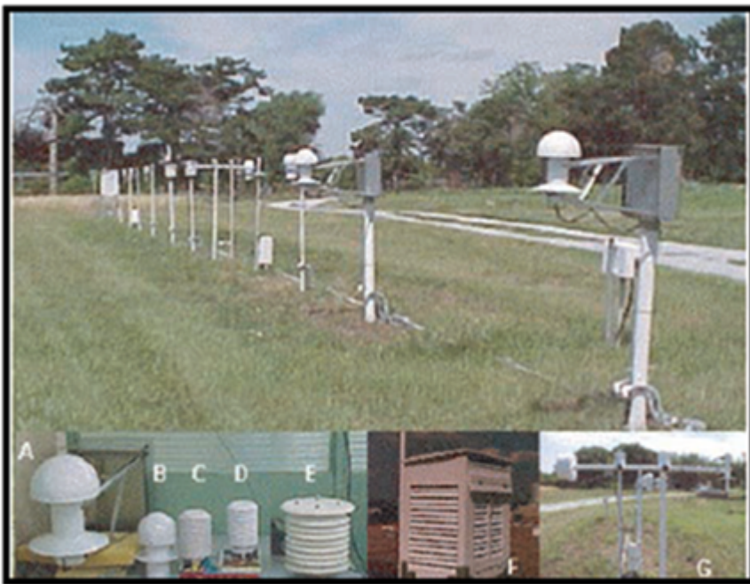
Abbildung 7: Kalibrierungs-Experiment an der University of Nebraska in Lincoln (aus (11), Abbildung 1); E, MMTS shield; F, CRS
