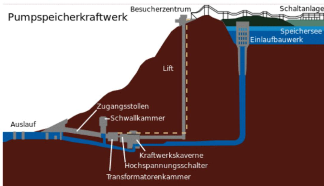
Bild 2. Schemadarstellung eines Pumpspeicherkraftwerks (Racoon Mountain) (Grafik: Wikipedia)
