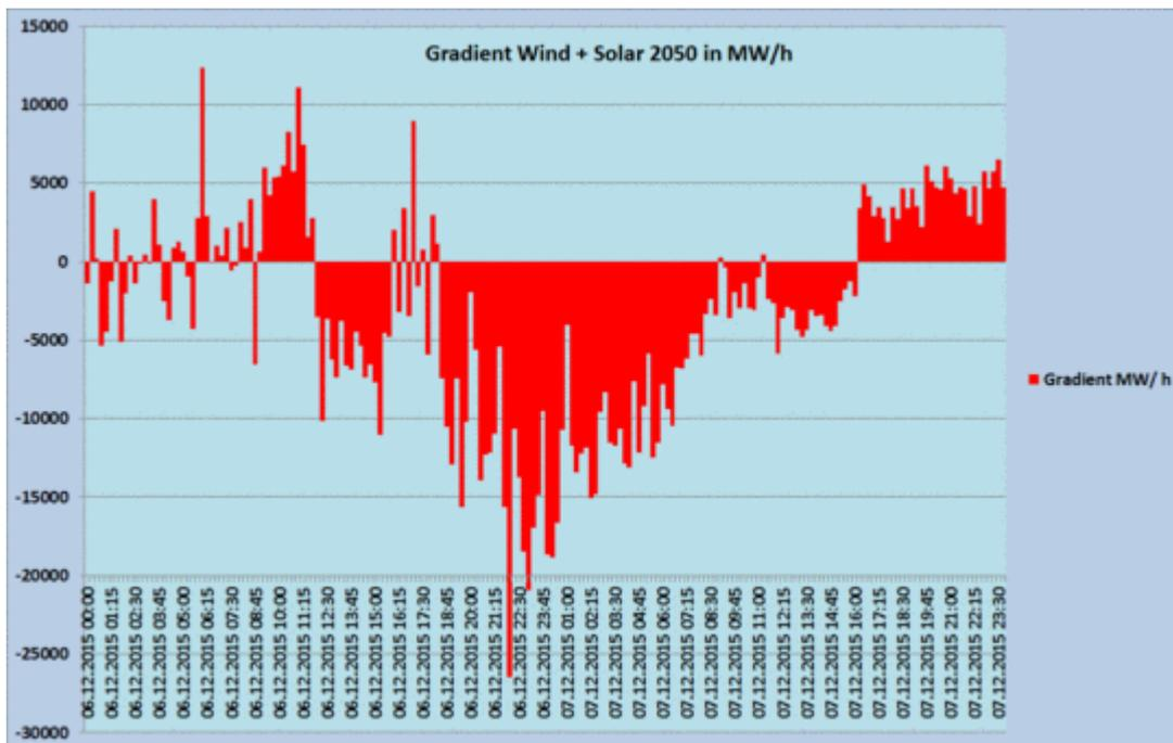
**Bild 9.** Die Auftragung der kurzfristigen Schwankungen des Aufkommens an Wind- und Solarstrom bei viertelstündlicher Auflösung zeigt ein ruheloses Hin und Her mit Amplituden bis zu mehr als -26.500 MW/h (Grafik: Autor)
