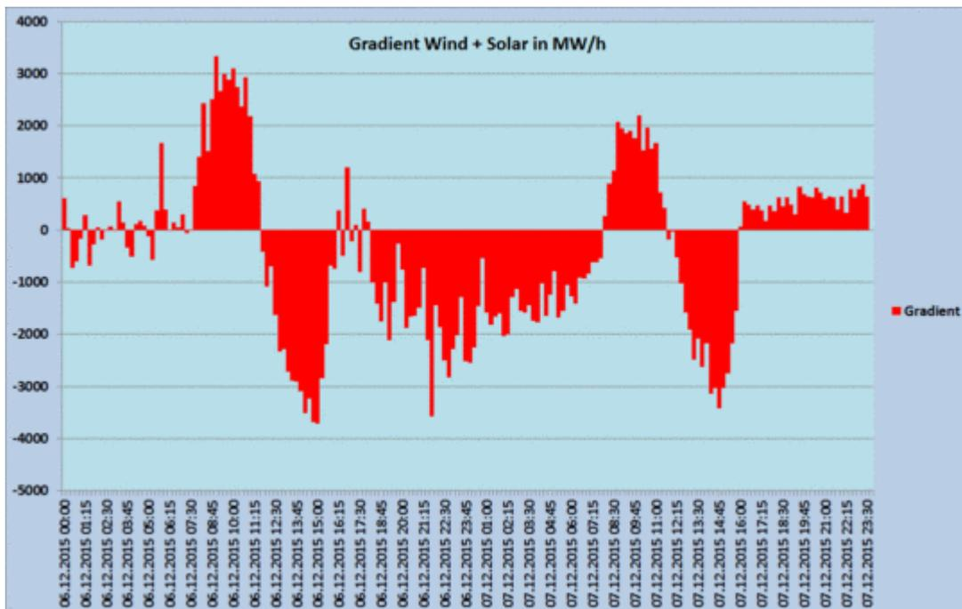
**Bild 6.** Die Auftragung der kurzfristigen Schwankungen des Aufkommens an Wind- und Solarstrom bei viertelstündlicher Auflösung zeigt ein ruheloses Hin und Her mit Amplituden bis zu mehr als 3.700 MW/h (Grafik: Autor)
