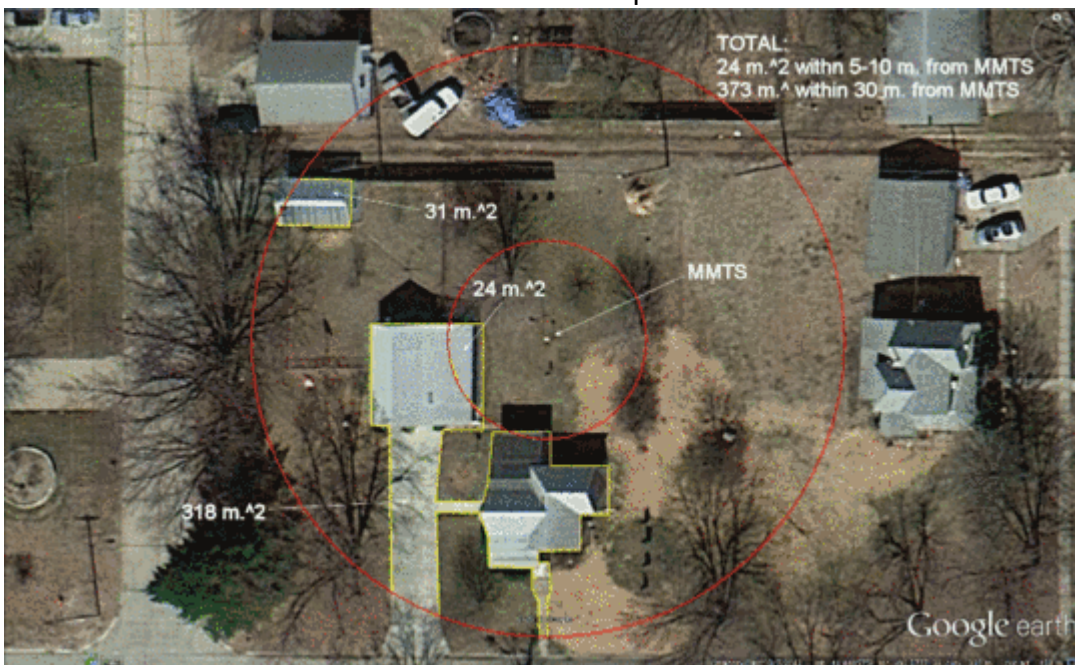
Bild 2 – Analyse der künstlichen Oberflächen innerhalb von 10 und 30-Meter-Radien an der Ashland, NE USHCN Station (COOP # 250375) mit Google Earth-Tools. Der Temperatursensor der NOAA ist als MMTS markiert
