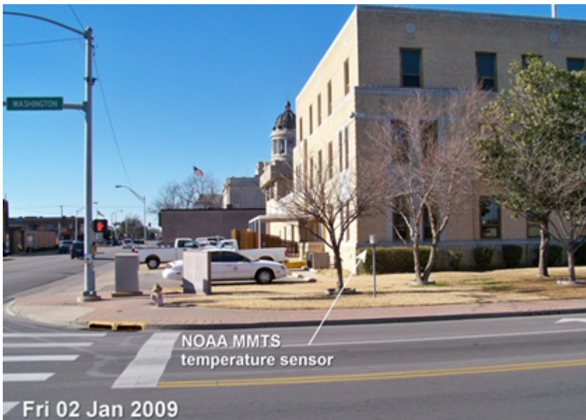
Bild 1 – USHCN Temperatur Sensor an einer Straßenecke in Ardmore, OK, in vollem Sichtschatten mehrerer Hitzequellen.
