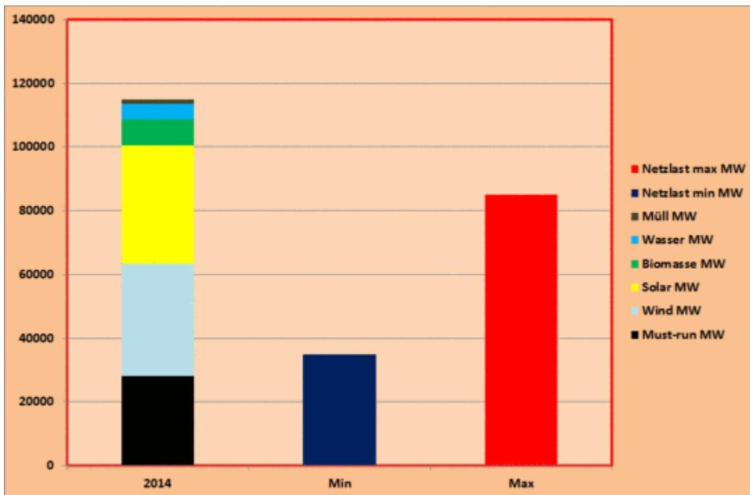
***Bild 3. Kombinierte Kapazität „erneuerbarer“ Energieerzeuger im Jahre 2014. Die Balken für minimalen und maximalen Strombedarf (Mitte und rechts) kennzeichnen die typischen Grenzwerte der Gesamtabnahme im Netz je nach Wochentag und Tageszeit***
