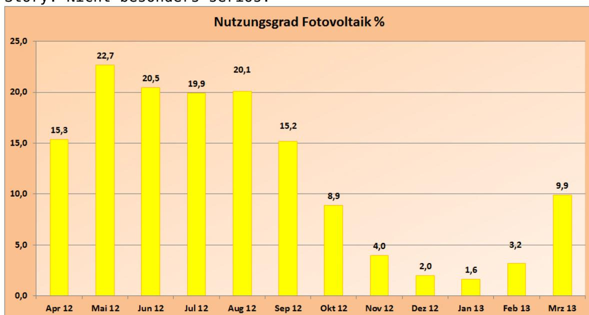
**Bild 1.** Monatliche Nutzungsgrade der in Deutschland installierten Fotovoltaikanlagen im Zeitraum April 2012 bis März 2013 (Daten: [EEX])
