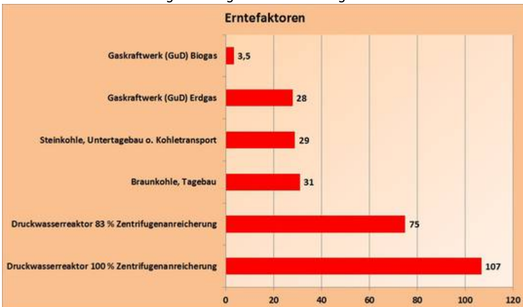
Bild 2. Vergleich der Energieerntefaktoren verschiedener konventioneller Kraftwerke (Daten: [FEST])
