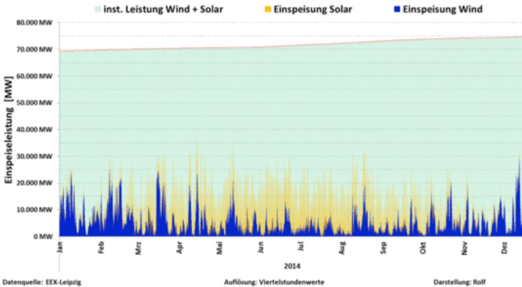
**Bild 2: addierte Einspeisung und Nennleistung von Wind und Solar bis zum 16.Dezember**
