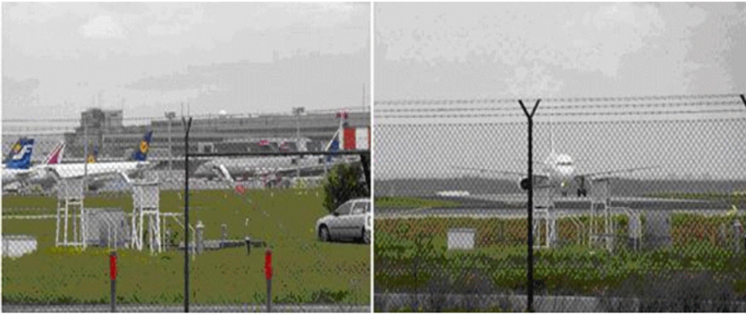
Abb.4 zeigt eine typische Flughafenmessstation (hier Frankfurt) im direkten Umfeld heißer (ca. 600°C) Triebwerksabgase. Bei Temperaturvergleichen, die sich im Zehntel-Grad-Celsius-Bereich abspielen, braucht nun wirklich niemanden erläutert zu werden, dass solche Vergleiche mit WI-unbereinigten Messstationen sinnlos sind.
