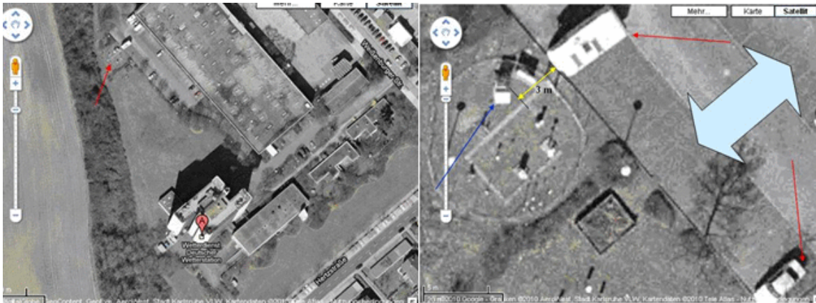
Abb.5 zeigt die langjährige DWD-Messstation Karlsruhe in unmittelbarer Nähe eines Parkplatzes. Die heiße Motorabwärme der Fahrzeuge steht über Stunden an. Auch mit solchen Stationen in der Nähe von Parkplätzen sind Temperaturvergleiche sinnlos.
