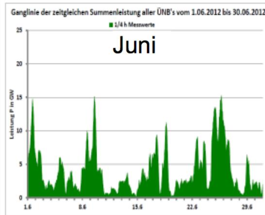
Die Verfügbarkeitsproblematik sei anhand der Leistungs- ganglinien der zeitgleichen Leistungseinspeisung in den ersten 6 Monaten 2012 aller Windenergieanlagen in Deutschland, die geamte installierte Leistung betrug 29.185 MW bei 22.664 Anlagen, erläutert:
