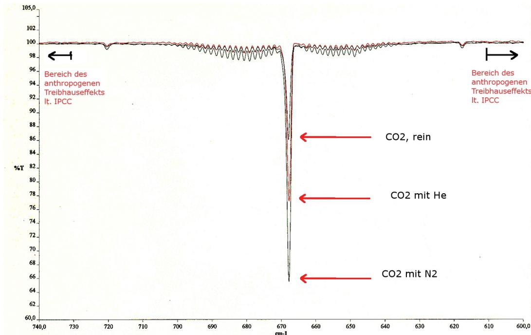
Bild 3: Spektrum von CO<sub>2</sub> (rein) und in Gegenwart von He sowie N<sub>2</sub>
