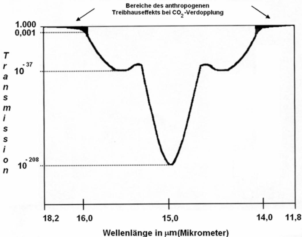
Bild 5: Spektrales Auswertungsschema
