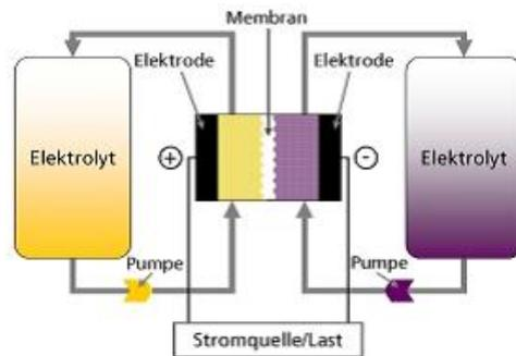
Abbildung 6-4: Schematische Darstellung einer Redox-Flow-Batterie<sup>85</sup>
