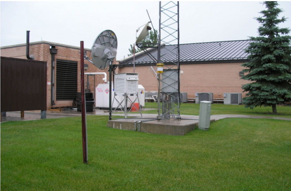
Abb. 6. Die Wetterstation in Grand Forks, North Dakota. Sie liegt am Wettervorhersagebüro der NOAA/NWS Eastern North Dakota. Die Wetterstation (Cotton Region Shelter (CRS)) liegt etwa 3 Meter vor den Belüftungsschlitzen der Klimaanlage für das Büro. Aus SurfaceStations.org
