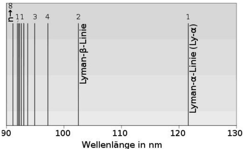
Abbildung 62 zeigt die Lyman-Serie. Sie ist eine Abfolge von Spektrallinien des Wasserstoffatoms im Ultraviolettbereich zwischen ca. 91-121 nm. Die Alpha-Linie hat mit 121,6 nm die größte Wellenlänge. Die Lyman-Spektrallinien werden von Astronomen für die Untersuchung von Sternen verwendet und gehen auf den amerikanischen Physiker Theodore Lyman zurück, der sie 1906 entdeckte.
