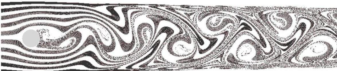
Abbildung 89 zeigt eine Kármán-Wirbelstraße. An einem Hindernis (links) wird die laminare Strömung gebrochen, dadurch kommt es zu links und rechtsdrehenden Wirbeln, die immer mehr Turbulenzen nach sich ziehen (S.d.W. 04/09, S. 79). In der Konvektionszone handelt es sich nicht um feste Hindernisse, sondern um Plasmamassen unterschiedlicher Geschwindigkeit, ähnlich wie auf dem Gasplaneten Jupiter.
