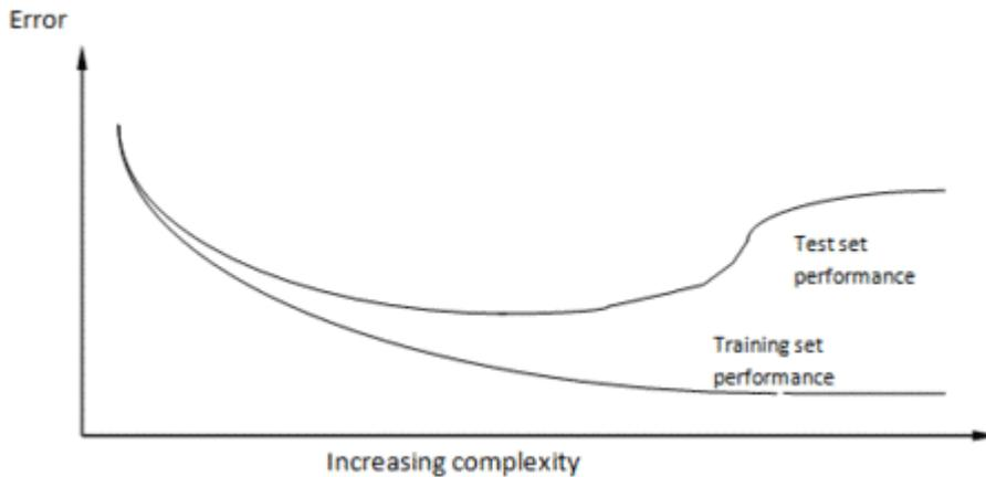
Wie zu sehen ist, wird die Leistung mit dem Trainingsdatensatz immer besser, je mehr Komplexität dem Modell zugefügt wird, auch die Leistung des Testdatensatzes wird besser, beginnt aber dann, schlechter zu werden.
