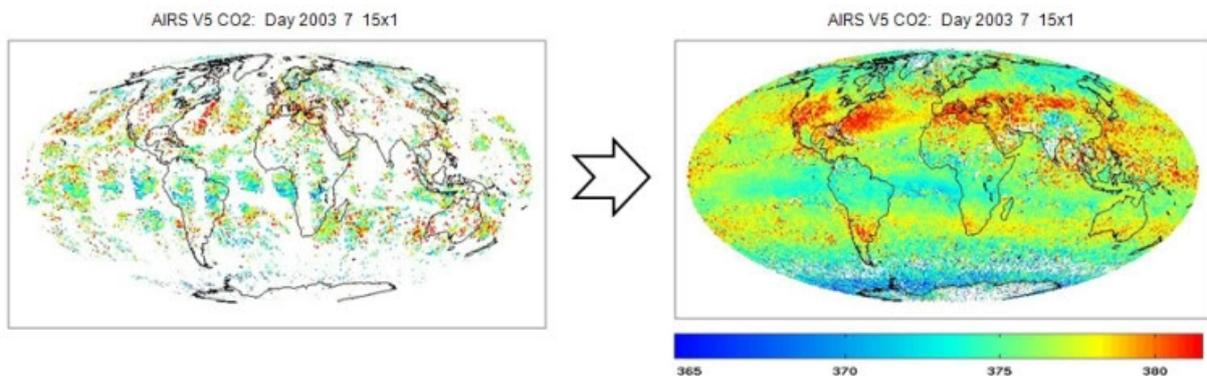
AIRS kann die Konzentration von Kohlendioxid in der mittleren Troposphäre mit 15 000 Beobachtungen täglich überwachen, von Pol zu Pol über den gesamten Globus mit einer Genauigkeit von 1 bis 2 ppm und einer horizontalen Auflösung von 1° zu 1°. Die monatliche Verteilung in der rechten Karte ermöglicht es Forschern, Variationen im CO<sub>2</sub>-Gehalt in verschiedenen Breiten und verschiedenen Jahreszeiten viel besser zu bestimmen. Bild: NASA
