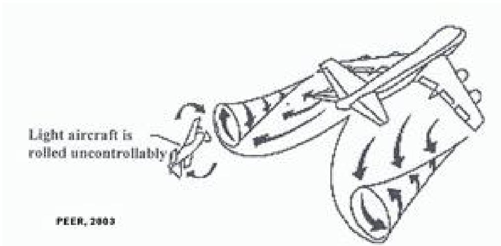
Abbildung 9 (Quelle: <http://www.muk.uni-hannover.de/forschung/allgemein/forschung/unfaelle.htm>) zeigt schematisch den Einzugsbereich und die Ausbreitung von Wirbelschleppen. Gut erkennbar, dass die heißen Abgase in die Wirbelschleppe mit einbezogen werden, anschließend verwirbelt und damit über ein großes Areal verteilt werden.
