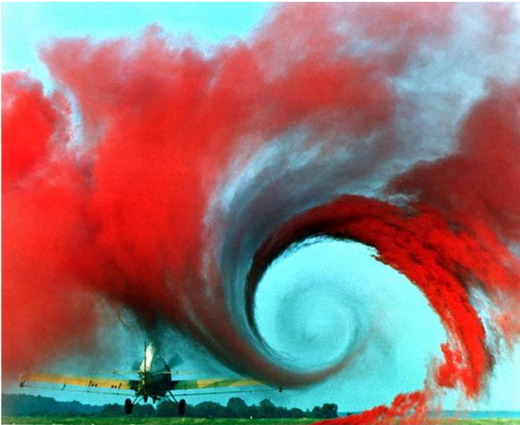
Abbildung 12, Quelle: NASA, zeigt am Beispiel eines Kleinflugzeugs recht anschaulich, wie solche Wirbelschleppen die Luftschichten hinter sich regelrecht durchquirlen. Bringen wir diese Erkenntnis in Relation zu Abbildung 7, so ist festzuhalten, dass mit jedem startenden oder landenden Flugzeug die Wetterstation regelrecht mit Heißluft aus den Abgasen der Verkehrsflugzeugen beaufschlagt wird. Dies gilt i.ü. grundsätzlich für alle Großflughäfen, wie noch gezeigt werden wird.
