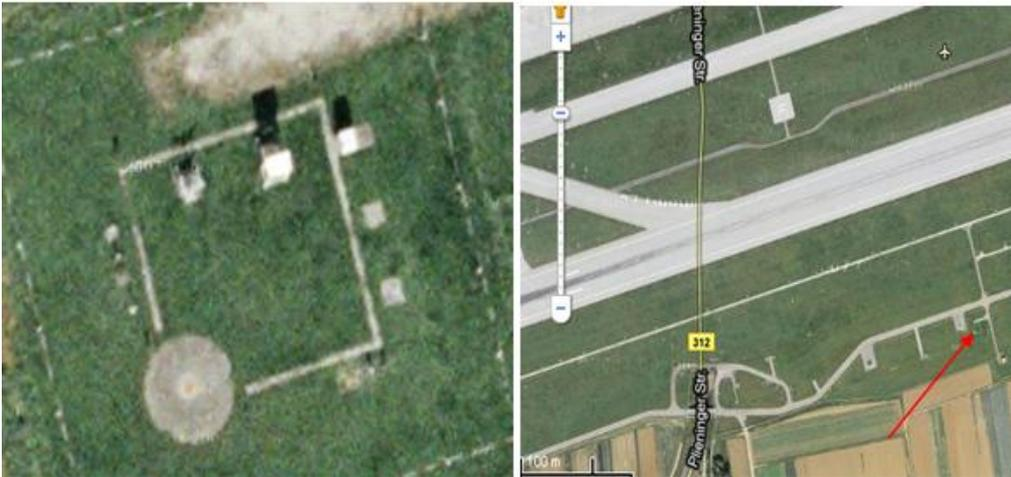
Die Luftaufnahme der Abbildung 21 zeigt, dass die Wetterstation unmittelbar neben der Star- und Landebahn liegt und nur ca. 150m von dieser entfernt liegt, womit die Station ebenfalls direkt in den Wirbelschleppenturbulenzen liegt und als Temperaturmessstation zu hohe Werte liefert.
