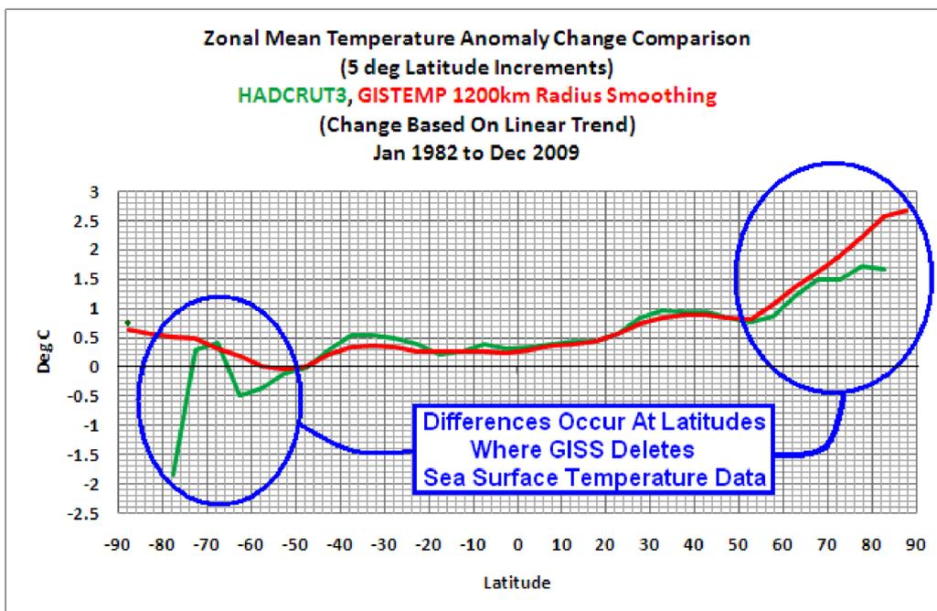
**Abb. 10 Vergleich der mittleren zonalen Temperaturanomalie für Segmente von 5° geogr. Breite GISTEMP mit 1200-km-Radius minus HADCRUT3 (Änderungen basierend auf dem linearen Trend) Jan 1982 bis Dez. 2009 Unterschiede zeigen sich dort, wo GISS Wassertemperaturen**
