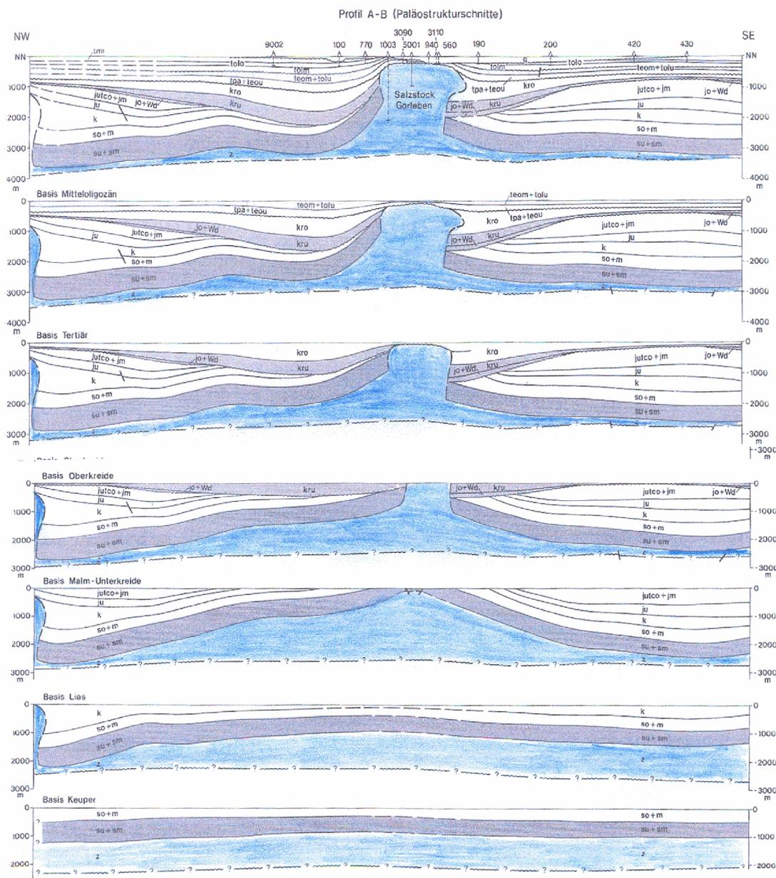
**Abbildung 1:** Zeitliche Entwicklung eines Salzstockes durch Salzaufstieg (Quelle: Bundesanstalt für Geowissenschaften und Rohstoffe – BGR)
